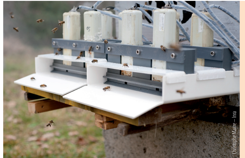
Ruche équipée d'un dispositif RFID pour enregistrer les entrées et sorties des abeilles.
